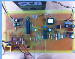
圖三：控制電路板
